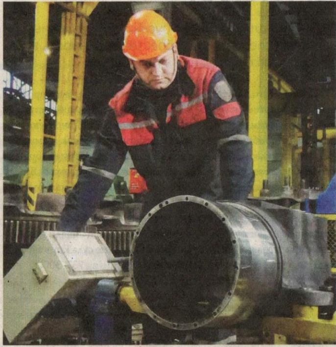
Слесарь по ремонту подвижного состава Сергей Минин выполняет внешний осмотр, очистку и дефектацию опоры колесной пары тепловоза.
