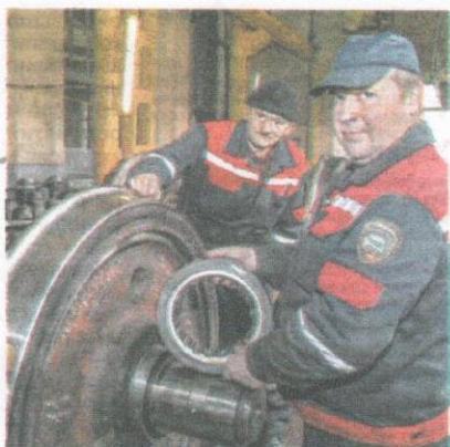
Идет процесс сборки колесных пар: токарь Александр Дрозд, слесарь по ремонту подвесного состава Игорь Стеликов.
